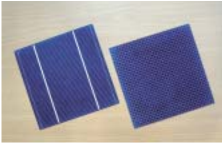
Vergelijking tussen een klassieke zonnecel (links) en een achtercontactcel (rechts).
