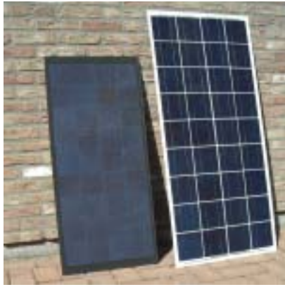
Vergelijking tussen een klassieke PV-module (rechts) en een PV-module met achtercontactcellen (links).
