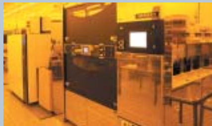
ASML PASS500/1100 belichtingstoestel voor 193 nm lithografie.
